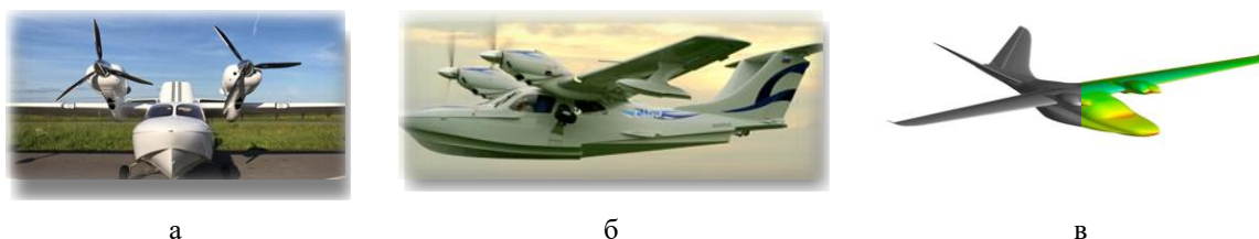
Рис. 5. Исходная (а, б) и оптимизированная (в) конструкция самолёта-амфибии на базе АС-24
